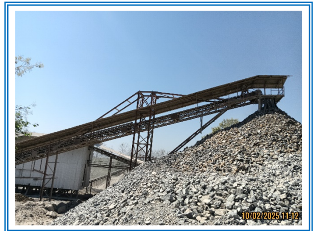
รูปที่ 3-15 สายพานลำเลียงแบบปิดคลุม
