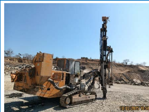
รูปที่ 3-7 เครื่องเจาะรูระเบิดที่มีอุปกรณ์เก็บฝุ่น ติดไว้กับหัวเจาะ
