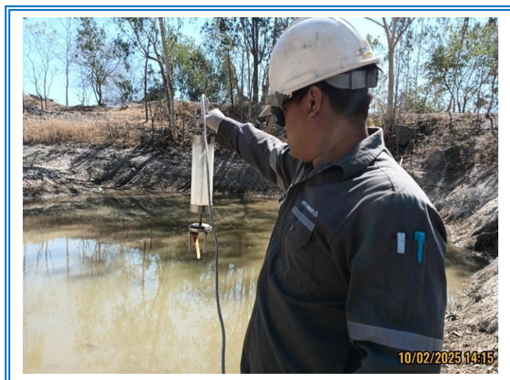
รูปที่ 4.3-12 แสดงการเก็บตัวอย่างเพื่อตรวจวิเคราะห์คุณภาพน้ำผิวดิน บริเวณบ่อดักตะกอนของโครงการ วันที่ 10 กุมภาพันธ์ 2568
