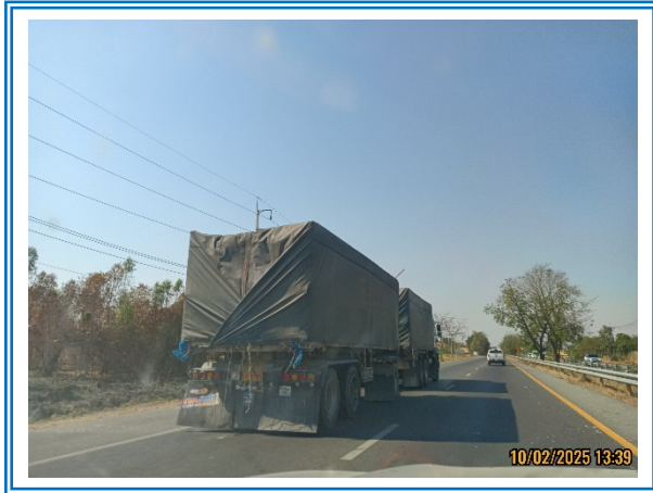
รูปที่ 3-12 การปิดคลุมรถบรรทุกด้วยผ้าใบมิดชิด
